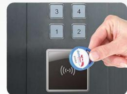
Aufzugsteuerung mit abgesetztem RFID-Leser.
