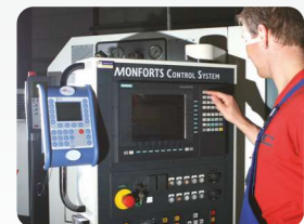
AE-MasterIV im Einsatz zur Maschinendatenerfassung. AE-MasterIV in use for machine data collection.
