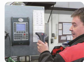
Betriebsdatenerfassung mit externem Barcode-Leser. Production data collection with external bar code reader.
